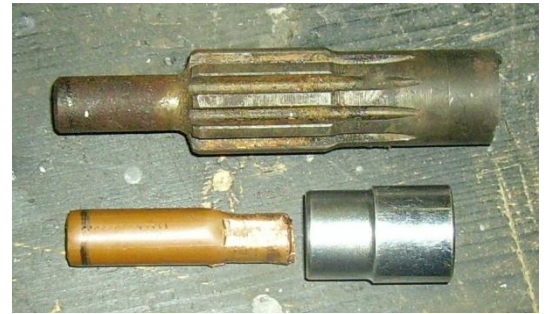
Oben abgesägte Getriebewelle und darunter die Teile für einen schnell selbst gebauten Kupplungsdorn
