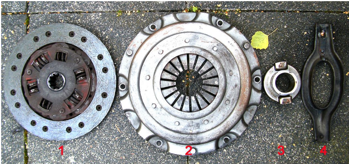
1 Kupplungsscheibe, 2 Druckplatte, 3 Ausrücklager, 4 Ausrückhebel
