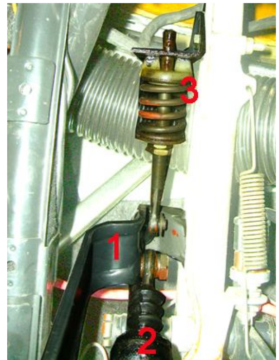
Einstellmechanismus am Kupplungspedal:
