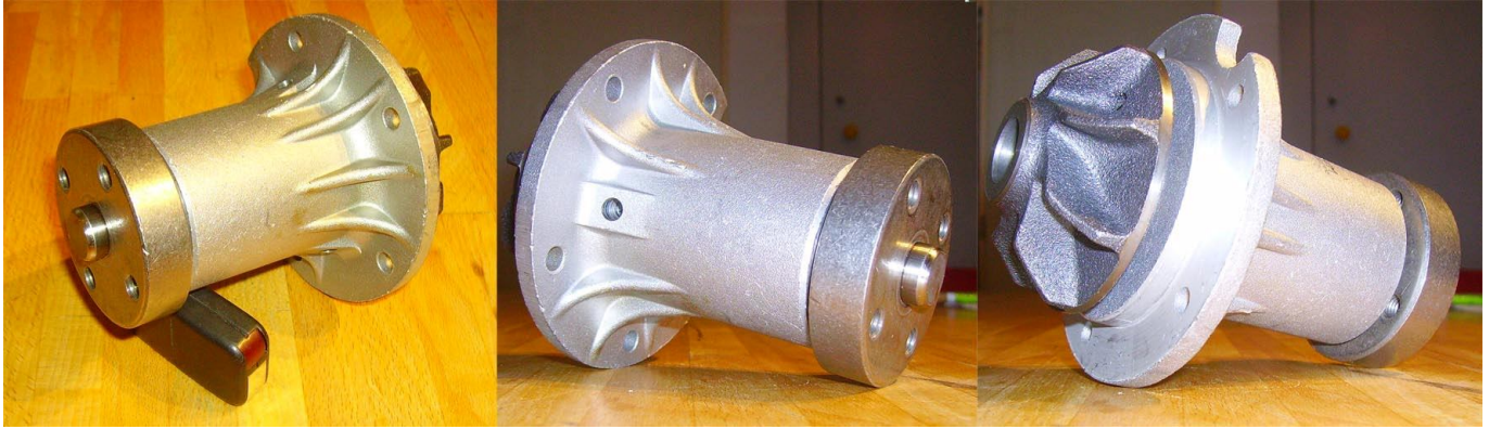
Die neue Wasserpumpe
