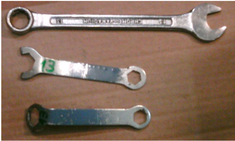
Bild: Spezialschlüssel für die schwierige Schraube an der Lenkungskupplung.
