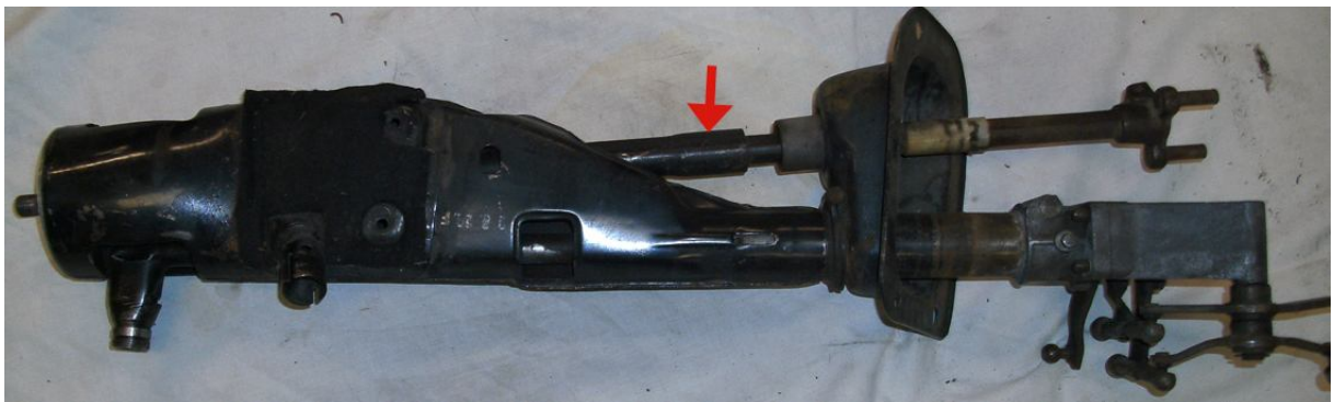
Bild: der Pfeil zeigt auf die Stelle, an der, durch zusammenschieben, eine Kürzung der Lenksäule möglich ist
