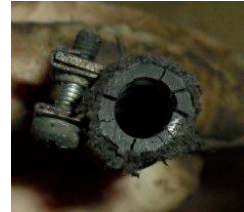
Abbildung 1: ein alter Schlauch - war zwar noch dicht, aber wie lange wohl noch....
